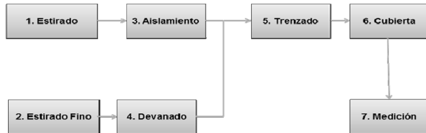
Diagrama 1. Proceso de producción de cable coaxial
